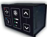
**Easy 3E** - Dispositivo da incasso su scatola 503 orizzontale. Gestisce le funzionalità di: on/off unità, scelta della portata di rinnovo fra le 3 preparate, protezione antigelo, rilevamento filtri sporchi e anomalia sonde temperatura. Alimentazione + comunicazione: cavo in dotazione 3 m (allungabile fino a 30m UTP cat. 5 o 5E).
